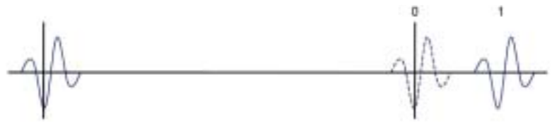
Figuur 5. PPM onderscheidt bits aan de hand van hun verschuiving in de tijd.
