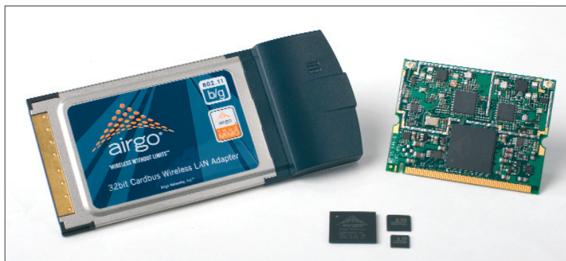
Die dritte Generation des Chipsatzes „True MIMO“ von Airgo erreicht Datenraten von bis zu 240 Mbit/s.
